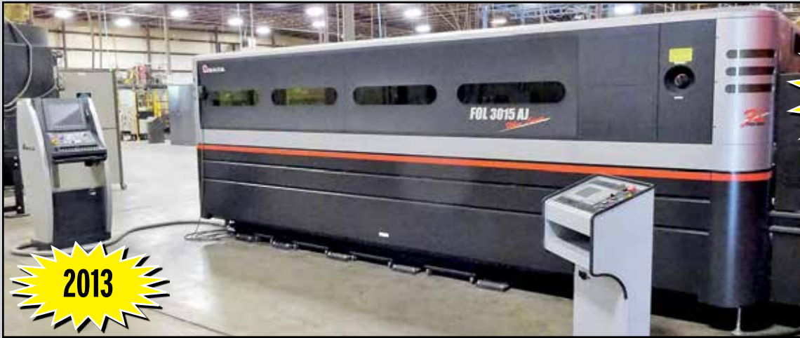
AMADA FOL 3015-AJ FIBER OPTIC CNC LASER
