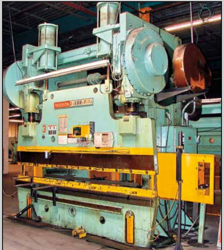
NIAGARA L-500-8-12 12' 500-TON PRESS BRAKE
