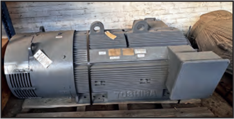
TOSHIBA 400 HP 2,300 VOLT 1,785 RPM MOTOR
